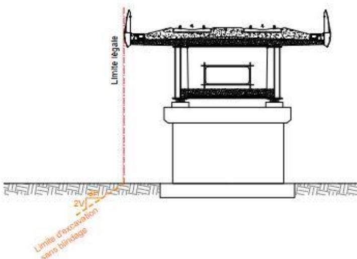
**Exemple 3 : matérialisation de la limite d'excavation, de terrassement et de fondation sans blindage à partir de l'emprise de la voie ferrée pour l'installation radio.**
